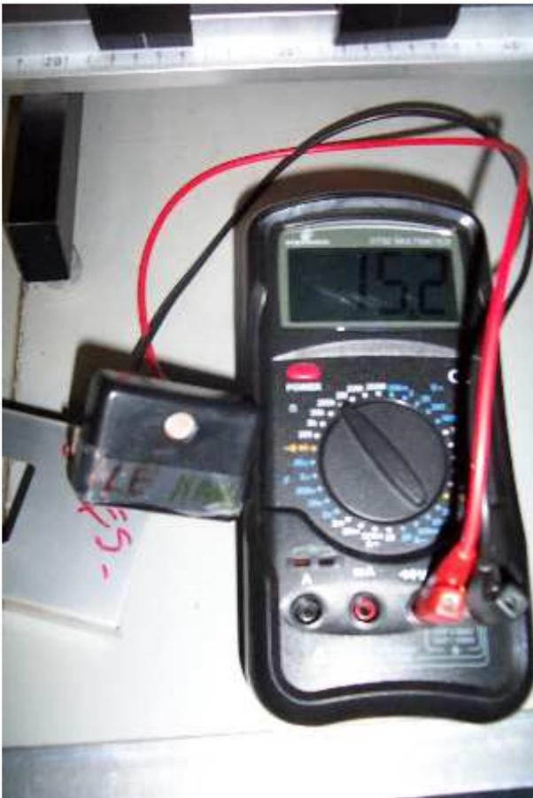
On positionne une photorésistance au niveau du cercle oculaire de manière à avoir un diamètre minimal de l'image de l'objectif sur la photorésistance.
