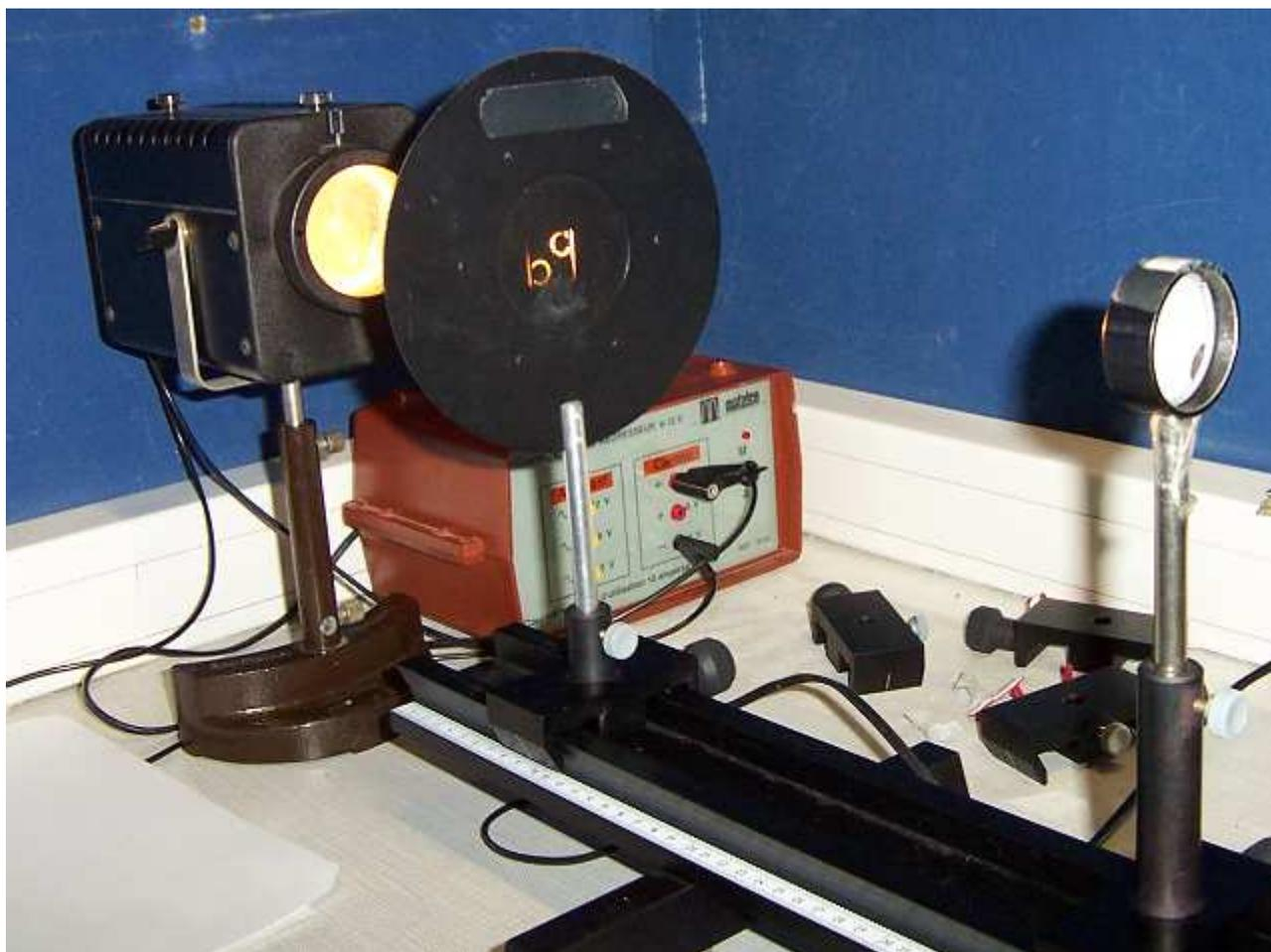
*on observe l'objet (q) et son image (b) situés tous deux dans le plan focal de la lentille par autocollimation (le miroir est accolé à la lentille et serti avec elle)*
